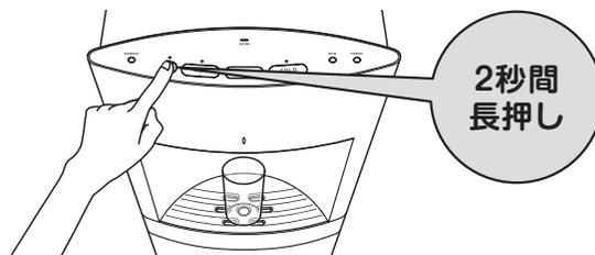
**2** UNLOCKランプが“点灯中”に **HOT** を“押し続ける”と出水されて、ボタンを離すと止まります。
